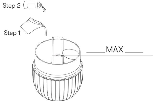
2. Wasser bis zum roten maximalen Wasserlevelindikator in den Wasserbehälter geben. 10–15 Tropfen ätherisches Öl hinzufügen.
