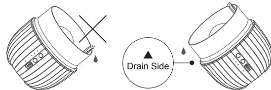
2. Das verbliebene Wasser über die Ausgussseite aus dem Wasserbehälter ausgießen.
