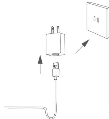
4. Das USB-C Ende des Kabels in den USB Eingang am Diffusor stecken und das USB-A Ende des Kabels in einen Adapter an der Steckdose oder eine Steckdose mit USB-Port anschließen.
